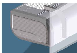
Im Lieferumfang: Bei der Wandbefestigung sind spezielle Wandhalter (Typ: WHK) mit Schwerlastdübeln an der Wand zu befestigen. Je nach Anlagenbaulänge werden 2 oder 3 Wandhalter benötigt. Die Luftschieieranlage kann dann über die T-Nut-Schrauben im Gehäusedach und den passenden Muttern (selbstsichernd) an der Wandhalterung befestigt werden.
