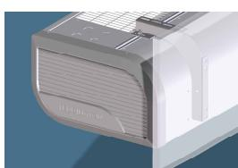
Dans le contenu livré: Pour l'accrochage en applique murale, il existe des consoles murales spéciales (type : WHK) à cheville spéciale lourde charge. En fonction de la longueur de l'installation 2 ou 3 supports seront nécessaires. L'installation à rideau d'air peut être fixée au support mural par des vis pour rainure en T dans le haut du boîtier et des écrous adaptés (indesserables).
