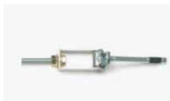
En option: Pour l'accrochage en plafond, en fonction de la longueur de l'installation, 4 à 6 fixations spéciales seront nécessaires de type DH/DHD vissées dans les rivets aveugles de la face supérieure de l'appareil et fixées dans le plafond au dessus de la porte grâce à des ancrages spéciaux lourde charge. Le réglage des tendeurs permettra de positionner l'installation à la bonne hauteur et horizontalement.
