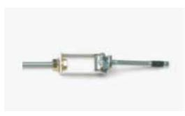
Opcional: En caso de fijación en el techo, según la longitud constructiva de la instalación, se atornillan 4 o 6 soportes especiales del tipo DH/DHD en tuercas de remate ciegas en la parte superior de la instalación y se fija en el techo por encima de la puerta con anclajes para cargas pesadas. Ajustando el torniquete, la instalación se coloca horizontal y a la altura adecuada.
