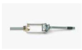
Optie: Bij plafondbevestiging worden, al naargelang de bouwlengte van de installatie, 4 tot 6 speciale houders van het type DH/DHD in de Blind-ein-klinknagelmatrijs op de bovenzijde van het apparaat vastgeschroefd en aan het plafond boven de deur bevestigd met zware ankers. Door de spanwartels te plaatsen wordt de installatie op de juiste hoogte waterpas gemaakt.
