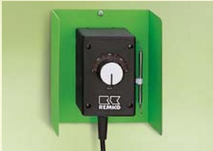
**Влагозащищенный комнатный термостат типа RT-5,** готовый к подключению, с мелкой градуировкой. Класс защиты IP 54. Влагозащищенный кабель длиной 10 м. с разъемом, защитный модуль из окр. листовой стали.
