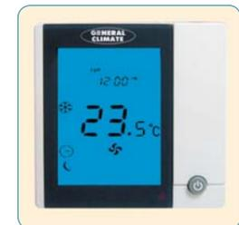
**GR2010DA-T74RL** Электронный термостат с таймером на 7 дней, регулятором скорости вентилятора и 3-х ходового клапана (2-х трубные фанкойлы). При достижении в помещении заданной температуры термостат перекрывает клапан. Вентилятор продолжает работать.
